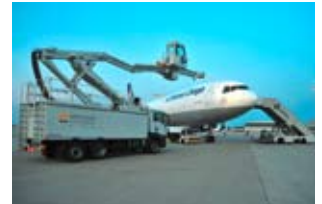
Enteisungsfahrzeug der Portground vor MD-11 der Lufthansa Cargo
